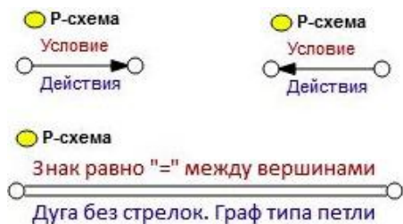
Рис. 3. Элементарная схема (одна дуга) вправо, влево и без стрелки для записи любой программы на любом языке программирования.
