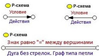
Рис. 3. Элементарная схема (одна дуга) вправо, влево и без стрелки, для записи любой программы в любом языке программирования
